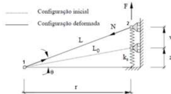
Figura 4 – Treliça plana constituída de uma barra e uma mola.
