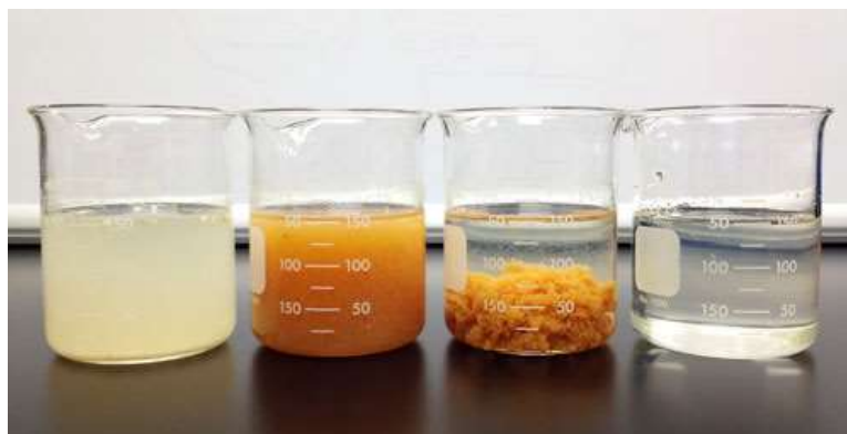
Figura 2 – Jar Test e as etapas de coagulação, floculação e decantação.
