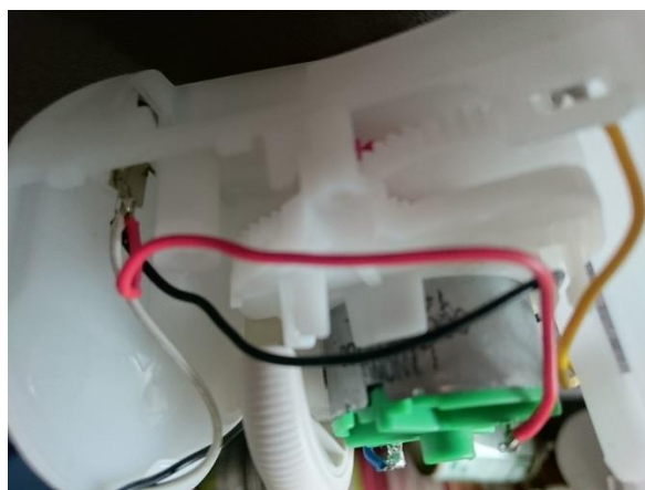
FIGURA 4 – HACKEAMENTO DA SAÍDA POSITIVA DE TENSÃO
