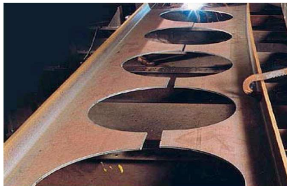
Figura 2 – Exemplo de fabricação de uma viga celular
