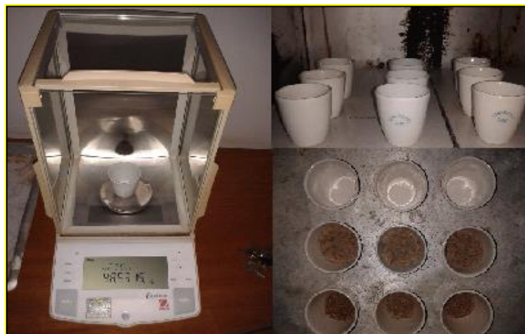
Figura 3: Caracterização do teor de umidade dos resíduos
