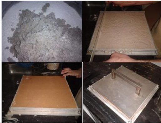
Figura 4: Processo de fabricação dos painéis.
