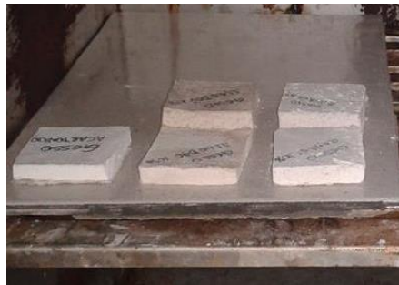
Figura 6: Amostra dos painéis A e B para ensaio de envelhecimento
