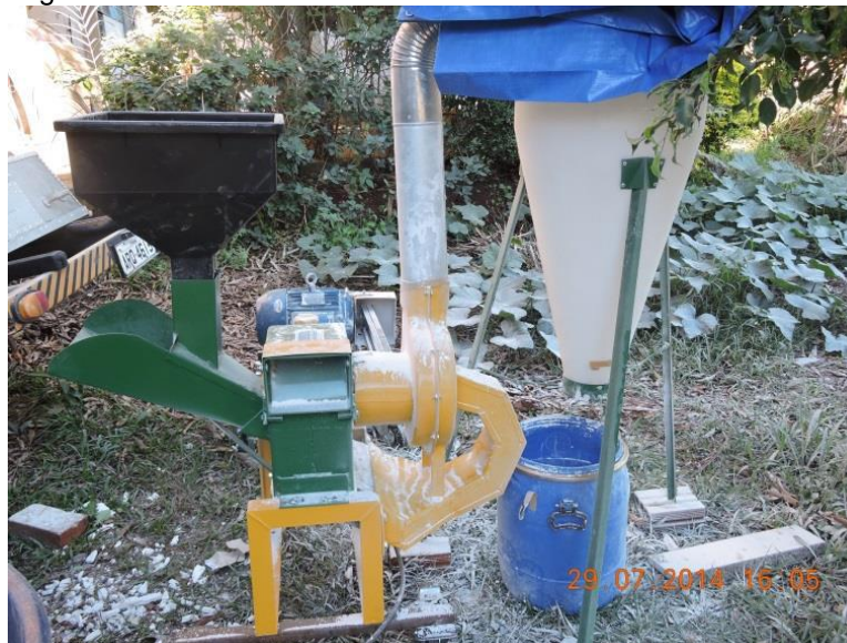
Figura 2: Desintegrador usado para trituração e moagem dos resíduos
