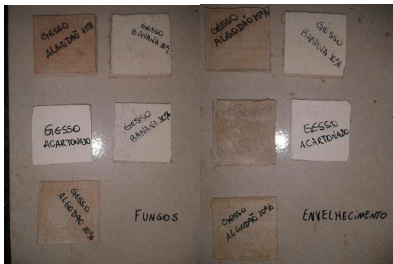
Figura 9: Amostras pós ensaio de fungos
