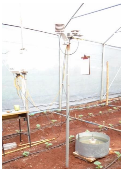
FIGURA 1: Estação climatológica automática e tanque reduzido.
