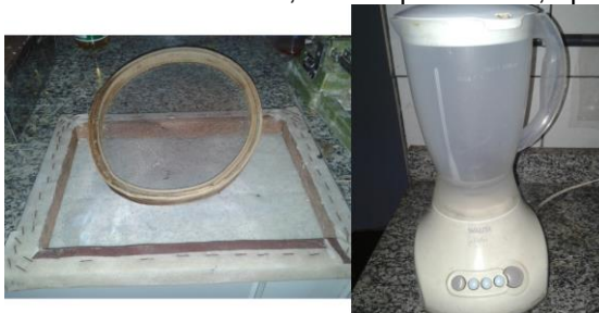
Figura 1 – Equipamentos utilizados na padronização da moinha de carvão vegetal
