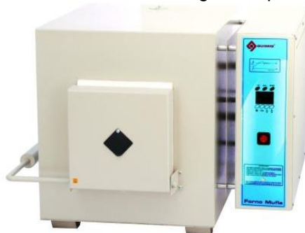
Figura 3 – Mufla utilizada na pirólise para obtenção do carvão ativado
