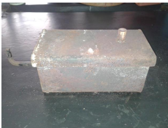
Figura 4 – Reator retangular utilizado na fabricação do carvão ativado
