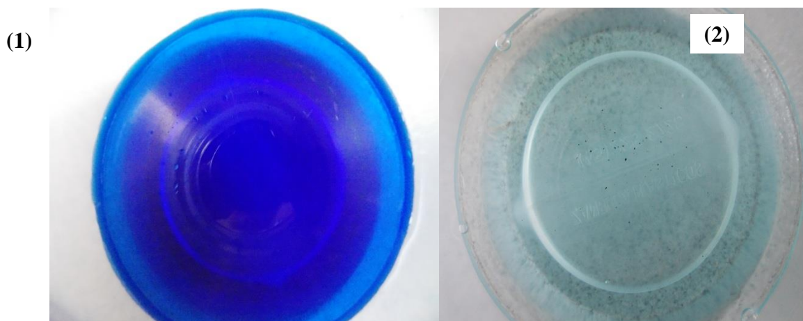
Figura 6 – Teste azul de metileno para o carvão ativado produzido
